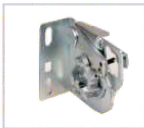
Paracadute molle (serie su tutti i portoni) Sistema di sicurezza che interviene bloccando la caduta del portone in caso di rottura dei cavetti di sollevamento.
